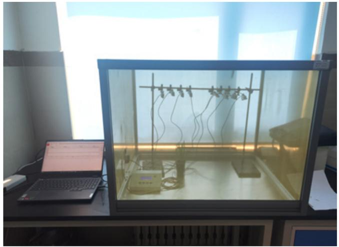
昆虫在刺吸过程中，会产生非常小的电势差，这种电势差通过信号放大器可以放大显示出来，由于昆虫在刺吸到取食过程中的电势不同，会显示出不同的波形，根据波形判断昆虫是否在取食。
